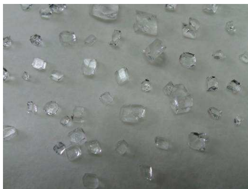
Рис. 7. Кристаллы, выросшие из раствора (10 мг / 100 мл \text{Fe}_2(\text{SO}_4)_3 \cdot 9\text{H}_2\text{O} и 0.2 г/100 мл \text{NaHCO}_3 ).
