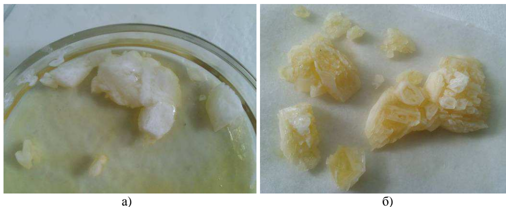
Рис. 6. Кристаллы с примесью \text{Fe}_2(\text{SO}_4)_3 \cdot 9\text{H}_2\text{O} . а) Содержание примеси \text{Fe}_2(\text{SO}_4)_3 \cdot 9\text{H}_2\text{O} : 200 мг /100 мл раствора. б) Содержание примеси \text{Fe}_2(\text{SO}_4)_3 \cdot 9\text{H}_2\text{O} : 100 мг /100 мл раствора.
